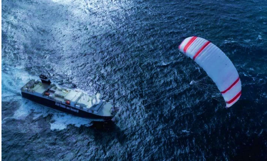
شکل ۱۲. یک نمونه کایت نصب‌شده بر روی یک کشتی ۱
