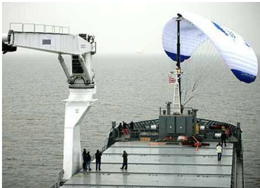
شکل ۱۴. کایت نصب‌شده بر روی یک کشتی باری ۱
