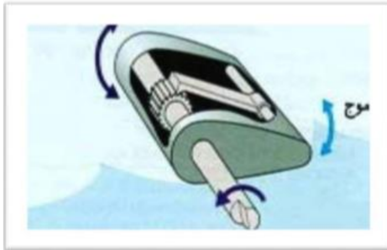
شکل شماره ۷. شماتیک یک بادامک شناور
