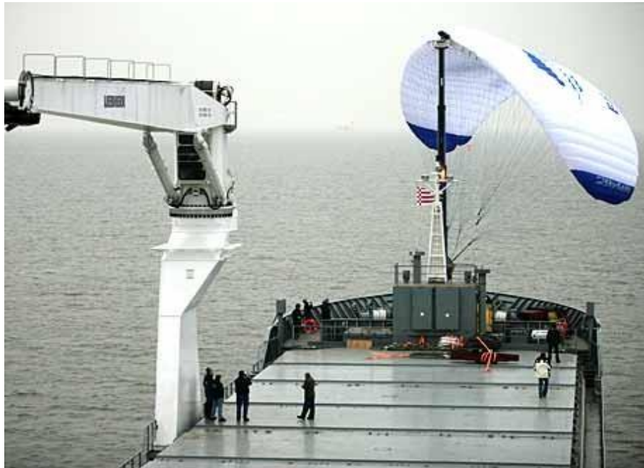
شکل ۱۴. کایت نصب‌شده بر روی یک کشتی باری ۱
