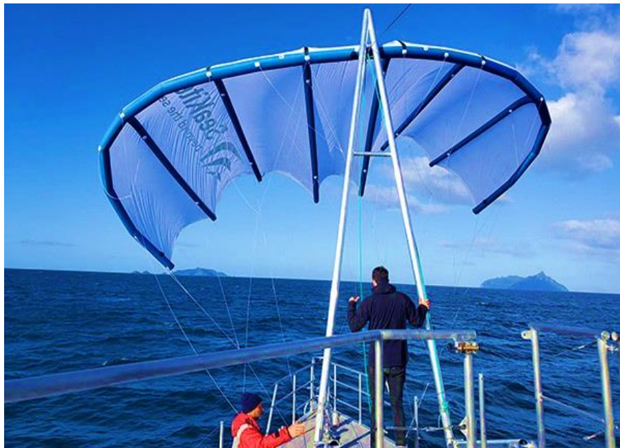
شکل ۱۵. تصویر فرایند بالا بردن / پایین آوردن کایت در سینه کشتی (Zhi Yong Tai, 2023)
